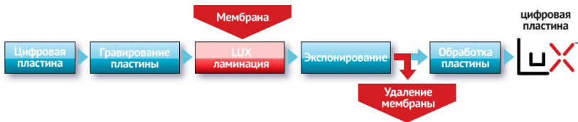
Рисунок 3 – Схема получения флексоформы с плоскими точками по технологии MacDermid
