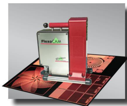
Рис.1. Контрольно-измерительное устройство Flexo Cam для оценки печатных форм
