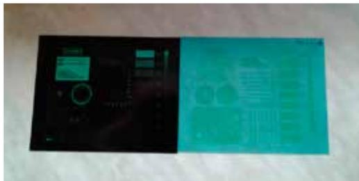
*Рис.1. Сравнительная фотография цифровой флексоформы Toyobo Cosmolight с масляным слоем (слева) и она же после промывки (справа)*
