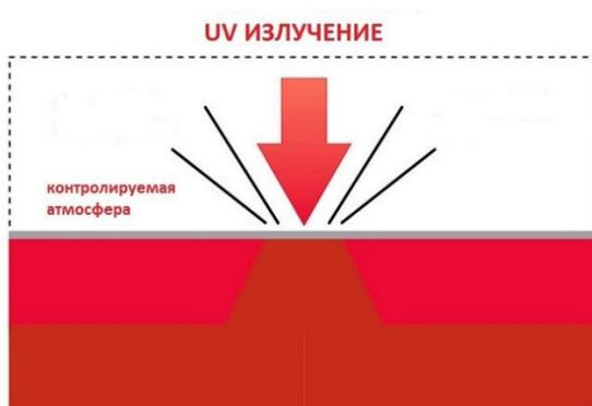
Рисунок 6 – Схема работы экспонирующей рамы DuPont DigiFlow
