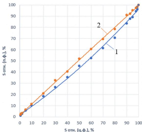
Рис.1. Градационная передача растрового изображения при линиатуре растирования 60 lpi на печатных формах: 1 – Cyrel® Easy EPC (SD); 2 – Cyrel® DEC (DC)
