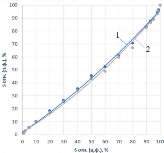
Рис.2. Градационная передача растрового изображения на печатной форме Cyrel® Easy EPC (SD) при линиатурах растирования:
