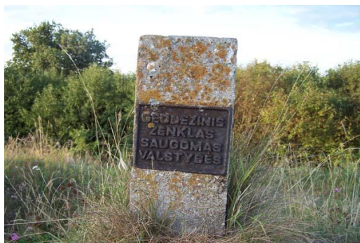
3 pav. GPS punkto ženklas (Prieiga per internetą http://www.qrz.lt žiūrėta 2018 m. rugpjūčio 13 d.)
