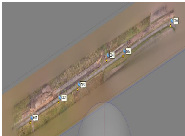
5 pav. Įrengtų kontūrženklių vietos (vaizdas Agisoft Photoscan Professional programoje)
