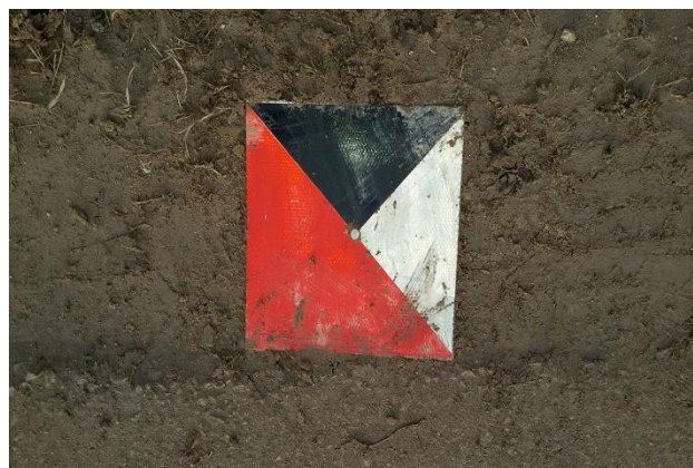
1 pav. Kontūrženklis naudojamas matuojant aukščius dronu.
